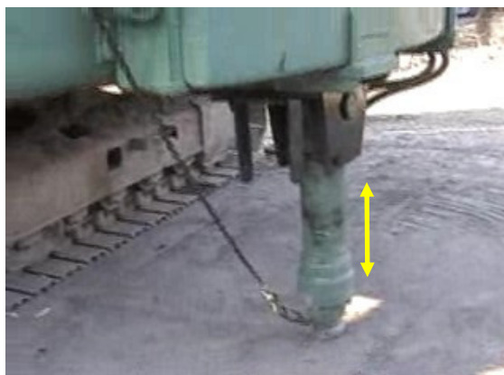
写真－5 キャタピラ方向転換用ジャッキ
