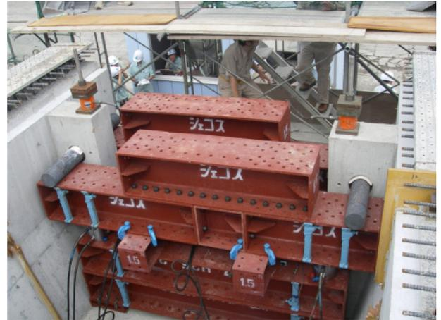
写真-3 実物大模型載荷実験状況
