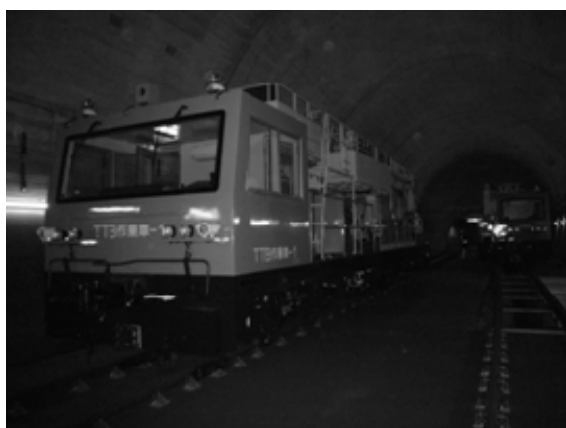
写真2 TTB取付作業車（吉岡横取基地）
