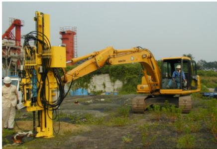
写真-1 プレストレス補強工専用機械
