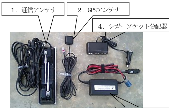
写真-2 外部配線機器
