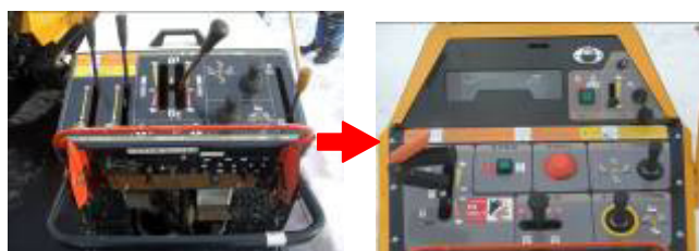
写真3 操作レバーの簡易化
