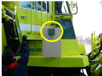
写真-10 RFIDアンテナ
