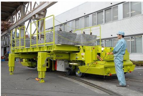
写真－3 軌陸式重量物運搬台車
