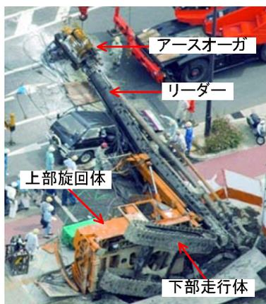
写真1 自走式くい打機械の転倒災害
