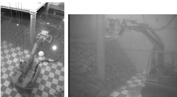
図-14 水槽内での肉厚計測実験
