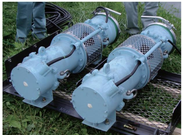
写真-2 7.5m<sup>3</sup>/min 排水ポンプ
