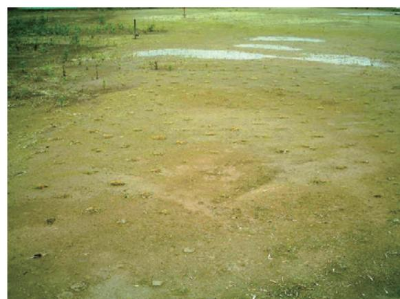
写真-9 有機酸浸透地盤1年後苔繁殖状況
