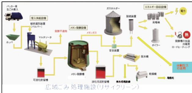
図-2 高速メタン発酵処理施設
