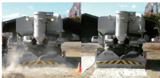
写真-7 回収なし（左）と回収あり（右）の発塵状況の違い
