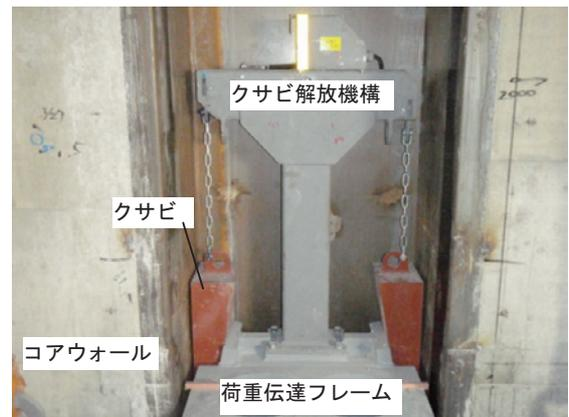
写真-5 くさび制御装置
