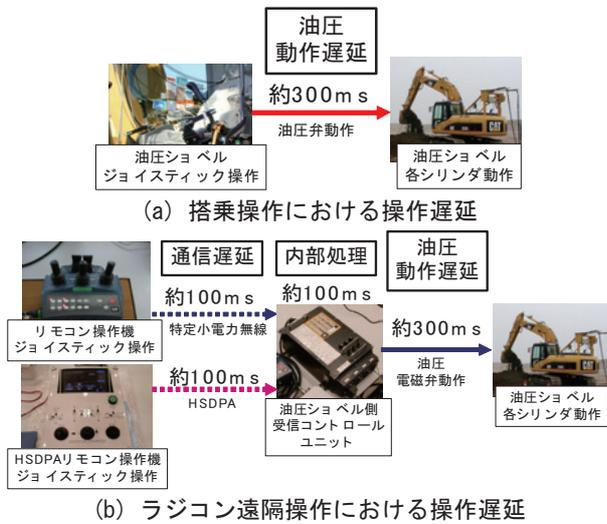
図-11 搭乗操作及びラジコン操作における操作遅延
