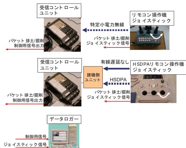
図-10 通信遅延計測実験システム構成図
