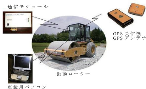
図-8 VRS-GPSシステム構成例（振動ローラ）
