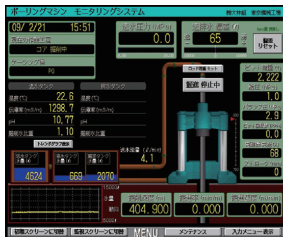
図-2 掘削モニタリングシステムモニター画面
