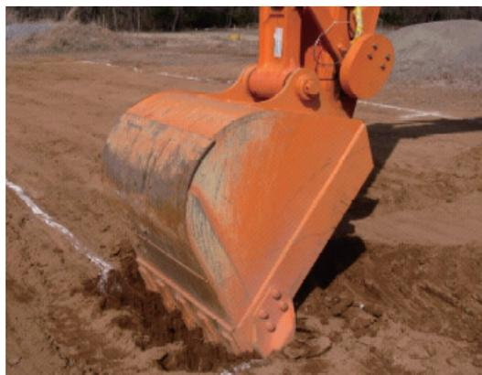
写真-8 掘削に必要な荷重が得られない状態
