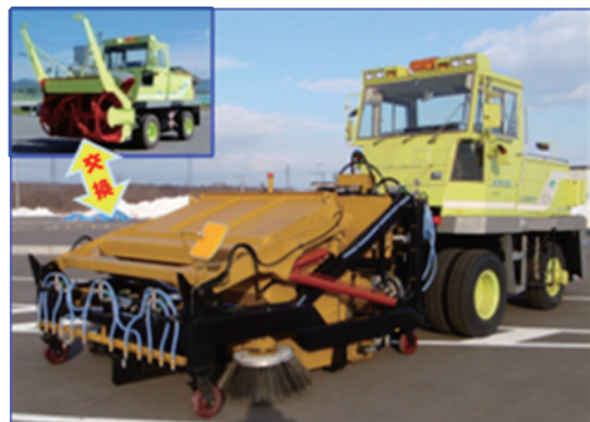
写真-1 ロータリ除雪車対応型路面清掃装置 (ロータリ除雪車両+試作機)
