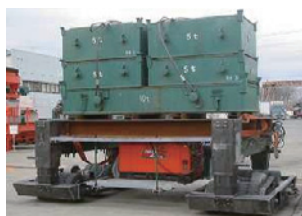
写真-2 積載能力・走行性検証
