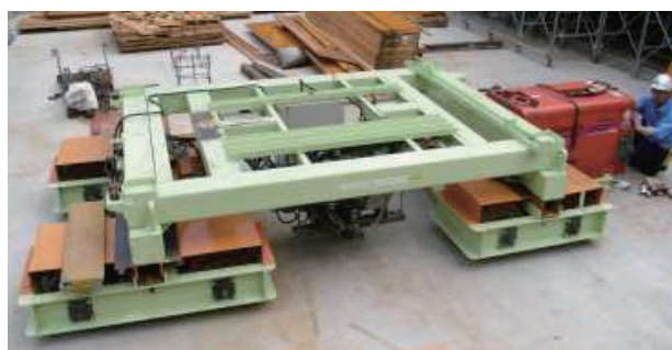
写真-5 組立状況（下部走行台車設置）
