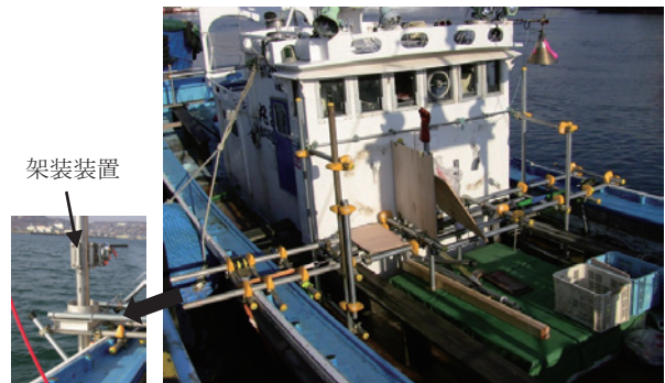
写真-9 単管パイプによる艀装用架台
