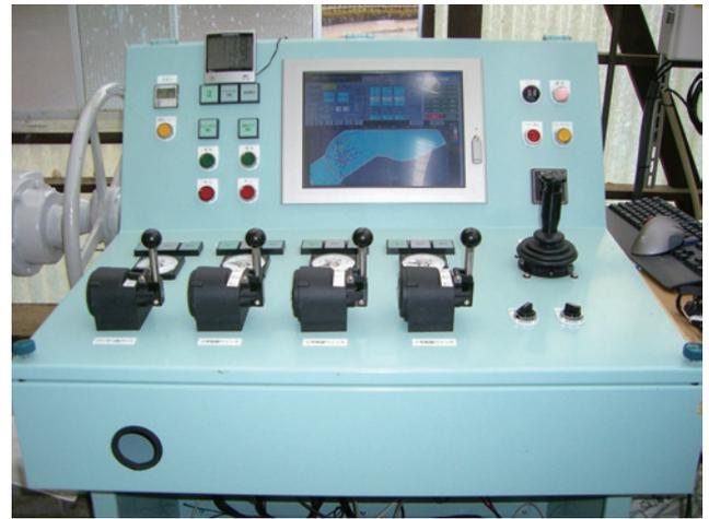
写真-3 遠隔操作盤「マジックコントローラー」
