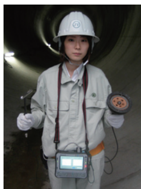
写真2 健コン診断ポータブル装着状況
