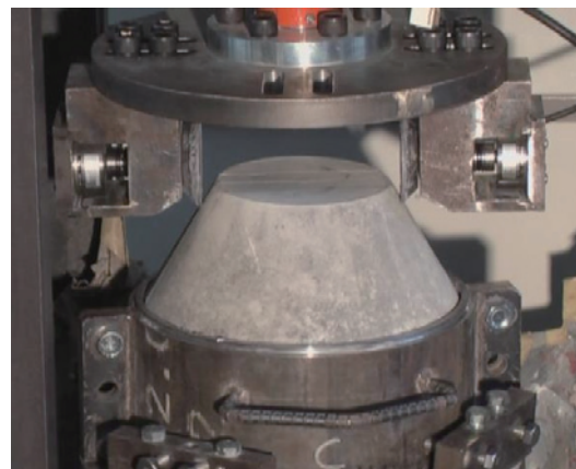
図-2 供試体とディスクカッタビット
