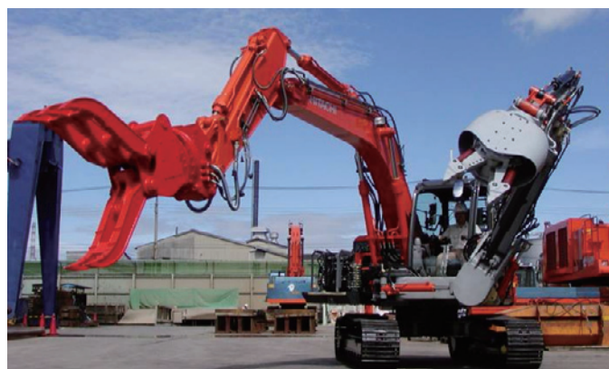
写真4 13t級双腕型油圧ショベル(10式)
