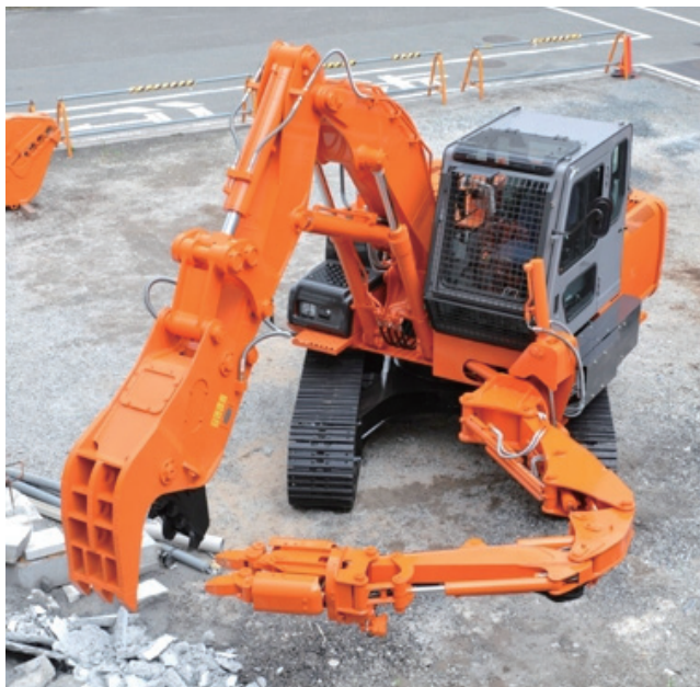
写真3 13t級双腕型油圧ショベル(08式)
