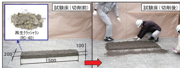
写真-8 飛石試験状況
