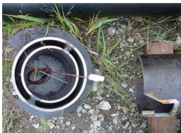
写真-2 先端部材の形状（改良したもの）
