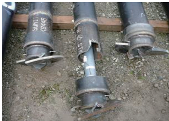
写真-3 先端部材の形状（改良したもの）
