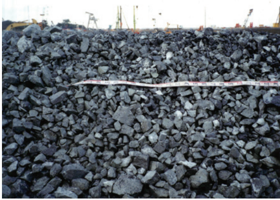
写真-2 掘削ずりの状況
