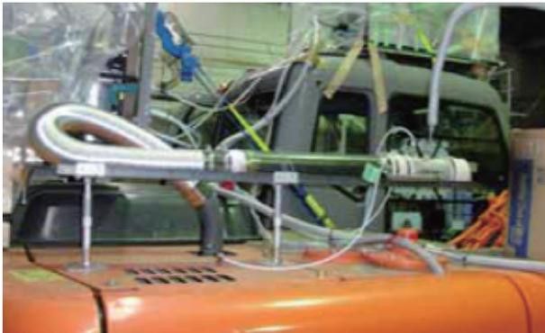
図-2 排出ガス流量計設置状況
