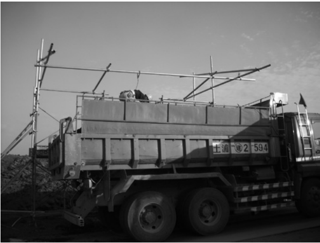
写真-1 ダンプシート掛け状況
