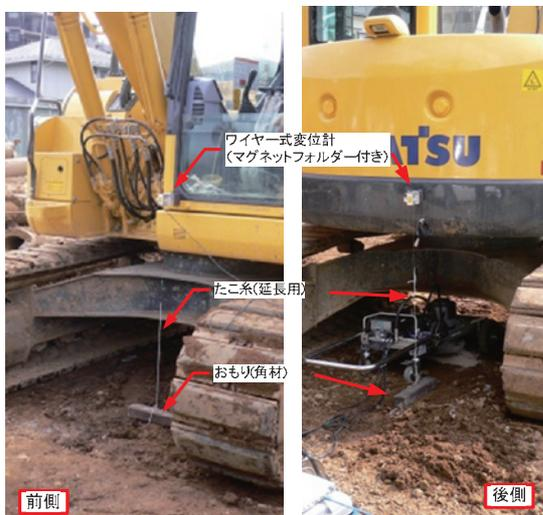
写真3 機体の浮き上がり変位量の測定
