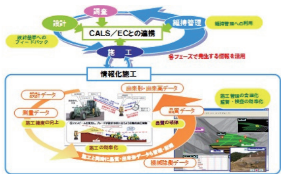
図-1 建設作業の生産性の向上を図る情報化施工
