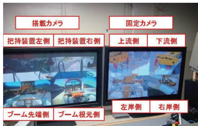
図-10 遠隔操作時のモニター状況
