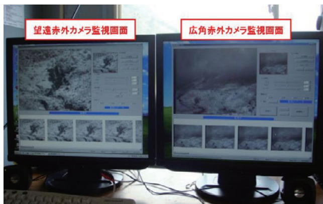
図-21 山体監視システム監視画面
