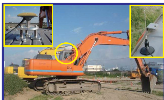
写真-3 掘削機械に搭載した GPS
