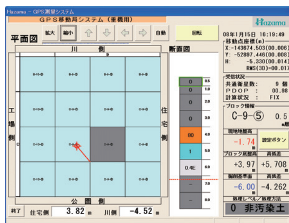
図-6 掘削機械に搭載したPC画面
