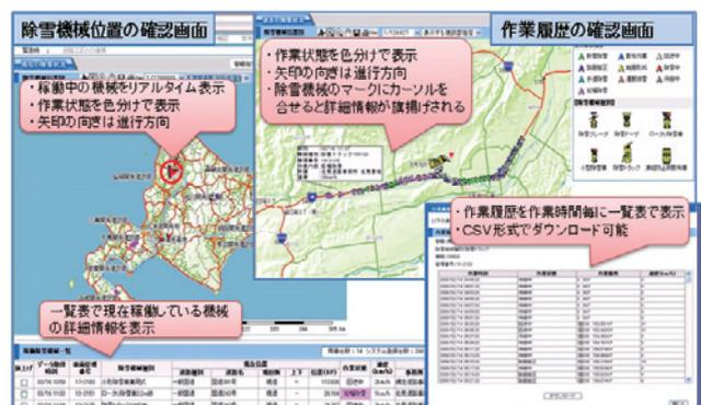
図-2 除雪機械位置・作業履歴の確認
