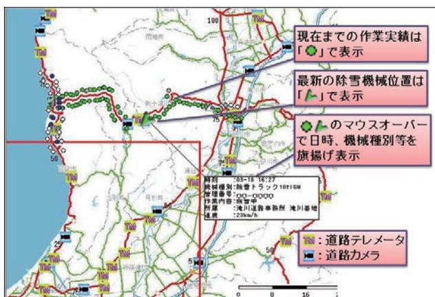
図-10 除雪作業状況確認システム
