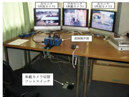
写真-2 遠隔操作室内のモニタおよび操作装置
