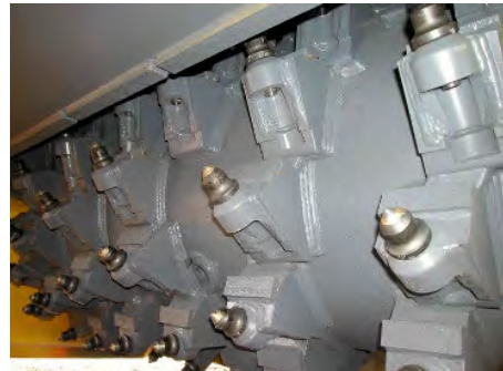
図1 岩盤切削機の切削ドラム 1)
