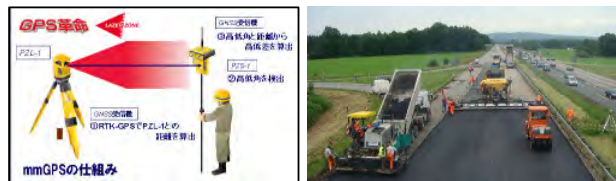
図-4 mmGPS 高精度かつ複数重機と測量の併用が可能。
