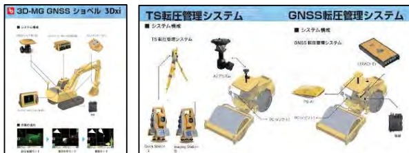
図-8 3D-MGショベル / 転圧管理システム構成
