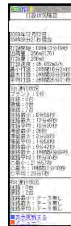
図-7 作業状況実時間遠隔モニタリングの携帯電話画面例
