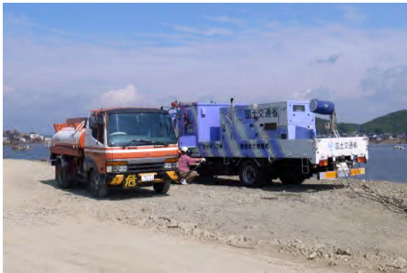
写真-3 分配状況(4tローリー車にて)
