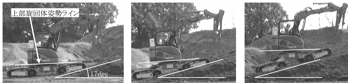
写真-3 姿勢水平制御実験
