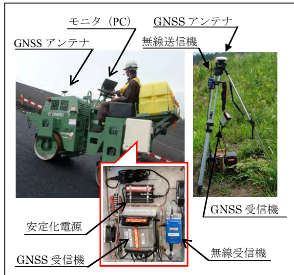
写真-1 RTK-GNSS の機器構成 移動局（左上）、基地局（右上）
