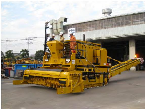
写真-1 地盤整正機全景
