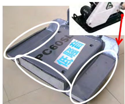
写真-2 制振材充填状況
