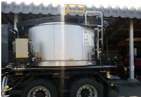
写真-4 クッキング釜チルト装置(傾斜前)
