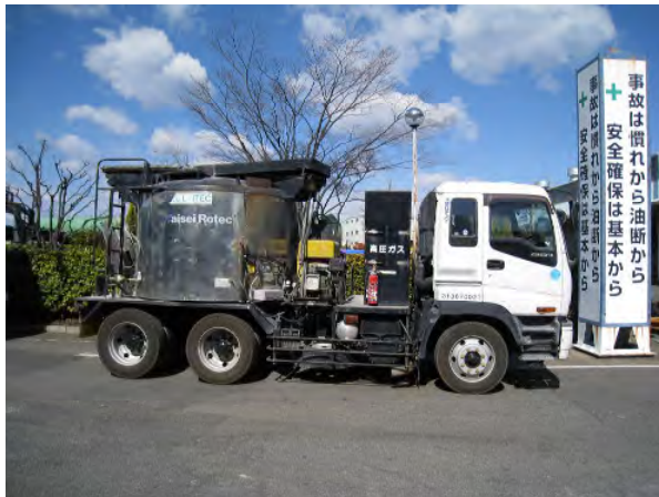
写真-1 LPG 加熱式アスファルトクッカー車外観写真
