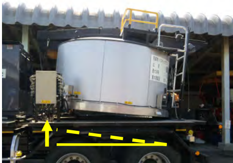
写真-5 クッキング釜チルト装置(傾斜後)
