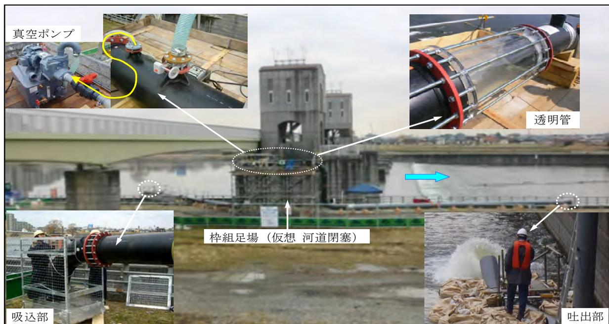
写真-1 モデル実験設備
