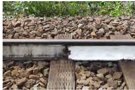
写真-9 洗浄性確認試験結果 (オイル汚れ)
