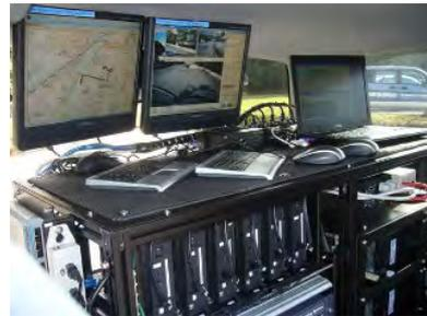
写真-3 MMS の車内搭載機器
