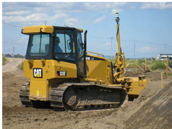
図-13 津波堆積物の剥ぎ取りに用いたブルドーザ（キャタピラージャパン社 D3K）
