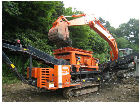
図-3 作業の外観（日立建機 VR408(左)，右のパワーショベルは ZAIS200)
