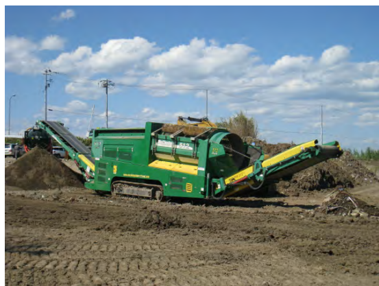
図-14 ガレキの除去に用いたトロンメル
